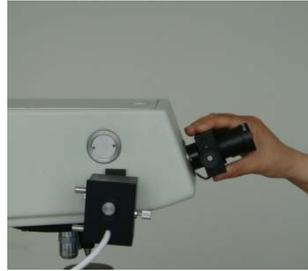
**Abbildung 3-4 Installieren des Messmikroskop**
